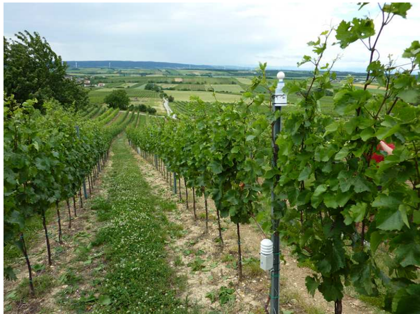
Slika 13.2 Stanica za merenje preseka klime vinograda (temperature vazduha i zemljišta, vlažnost vazduha, isparavanja) na brdovitom terenu u Austriji (uporediti rezultate izvedene na osnovu Slike XX i Slike XX u drugim poglavljima)
