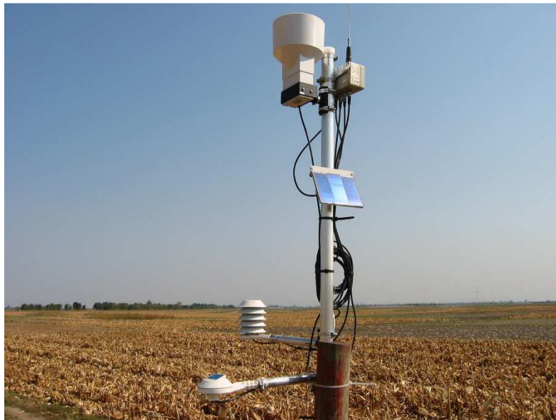
Slika 13.4 Primer komercijalne automatske agrometeorološke stanice na solarni pogon za merenje standardnih meteoroloških parametara i “online” prenos podataka
