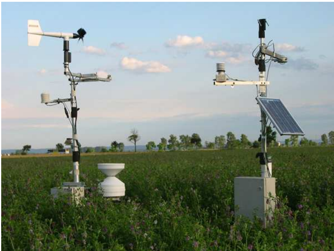
Slika 13.20 Agrometeorološka stanica (sa raznim senzorima) u polju lucerke za određivanje sadržaja vode u zemljištu (izvor: BOKU-Met).
